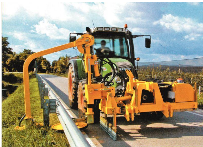
Figur 13: En fordon med ett speciellt anpassat slätteraggregat för vågräcken. 59
