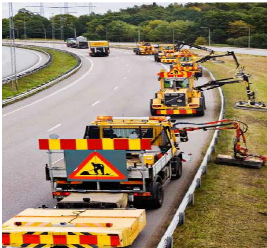
Figur 12: En bild av slätter på en motortrafikled. Här syns slätteraggregaten samt hur TMA-fordon har ställts upp för att öka säkerheten för förarna samt övriga trafikanter. 58
